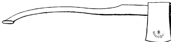
Erstlich ist sie noch einmal so breit im Hieb, vorne außerordentlich dünn, und die dickste Stelle des Blattes dort, wo sich in der Zeichnung das Sternchen befindet. Von dort aus läuft sie überall nach der Schneide zu dünner ab, so daß sie bei einem tiefen Hieb in grünes Holz nur immer an dem einen kleinen Punkt haften, und außerordentlich leicht, mit der geringsten Bewegung, wieder frei gemacht werden kann, ohne je zu klemmen.
